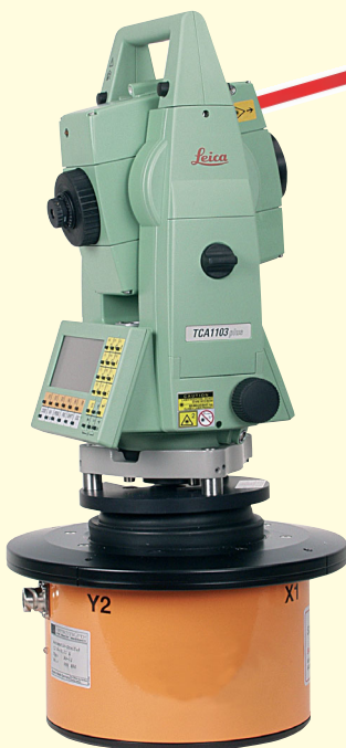
Láser teodolito basado en un concepto de VMT
